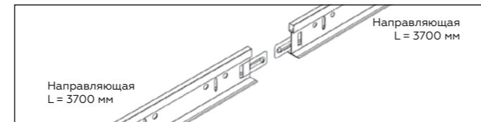
**Шаг 6.** По завершениюстыковки профилей, производится их выравнивание по уровню в одной плоскости, которую образует уровень периметра. Делается это с помощью регулировки «вверх-вниз» подвесов, на которых закреплены основные направляющие.
